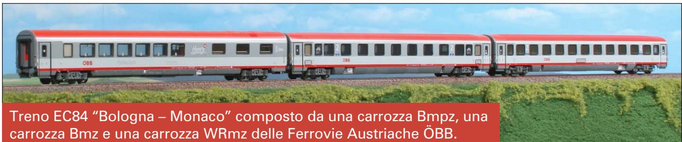
Treno EC84 "Bologna – Monaco" composto da una carrozza Bmpz, una carrozza Bmz e una carrozza WRmz delle Ferrovie Austriache ÖBB.
