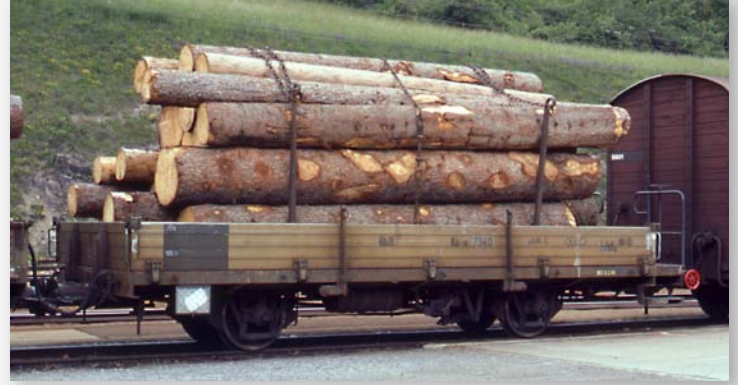
9463 110 Kk-w 7340 Niederbordwagen mit Klappungen für Holztransport
