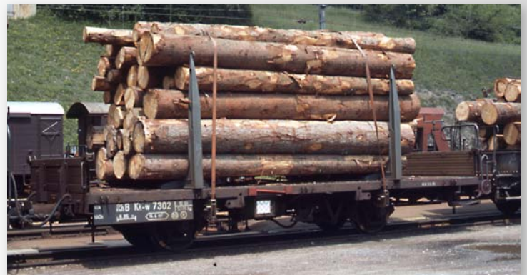
9463 110 Kk-w 7340 Niederbordwagen mit Klappungen für Holztransport
