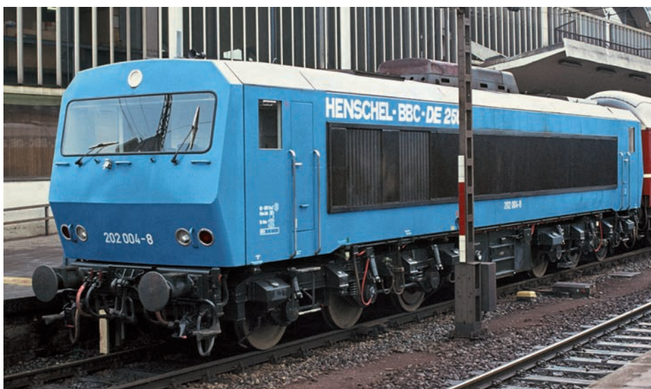
Lokmodell mit 2 dreiachsigen Drehgestellen, serienmäßig mit Kurzkupplungen
