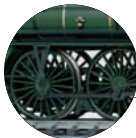
Riesige Treibräder – Durchmesser im Original: 2,20 m
