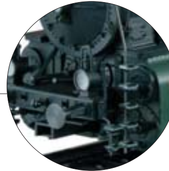
Freistehende Laternen und filigran angesetzte Aufstiegsleitern
