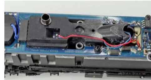
Eingebauter Raucherzeuger einer Class 66
