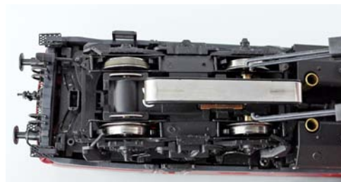
BR 215 mit aufgesetztem Schleifer
