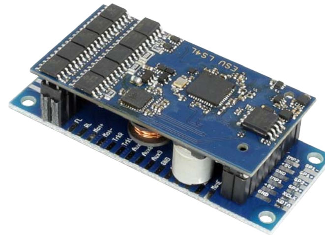
Decoder montiert auf Adapterplatine
