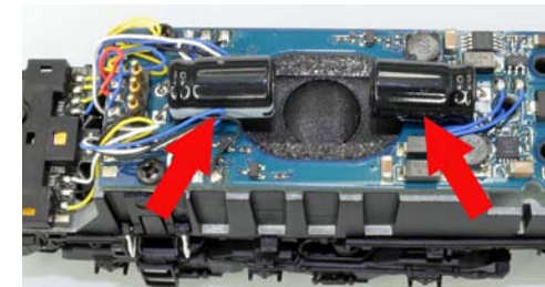
PowerPack Kondensatoren einer Class 66
