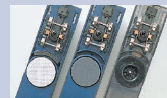
◀ Auswahl zwischen nass polieren, trocken schleifen und Staub saugen (von links)
