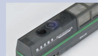
◀ Das Schienenreinigungsfahrzeug hat einen eingebauten Tank, um Reinigungsflüssigkeit zu sparen
