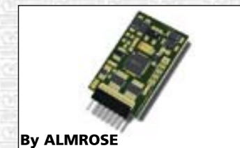
By ALMROSE 6087 Decoder funzioni per pilota Vivalto: gestione luci di marcia, terzo faro (digitale) autonomo, luce interna On/Off, regolazione luminosità luci interne e luci di marcia. Lighting decoder for Vivalto driving coach.
