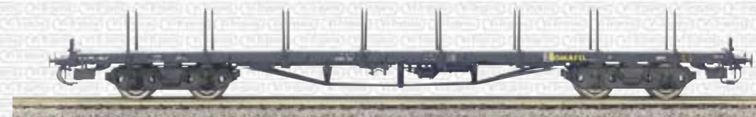
3314 Carro pianale tipo Rs del Portogallo "SOMAFEL", nuova numerazione. Rs flat car of "SOMAFEL" Portugal, new service number.
