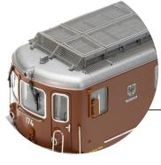
Gut sichtbar: Die Bremswiderstände unter den filigranen Ätzteilen aus dünnem aber stabilem Neusilberblech auf dem Dach unseres neuen Modells.
