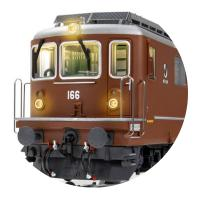
Die Führerstandsbeleuchtung kann im Digitalbetrieb zugeschaltet werden.
