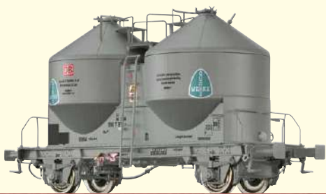
Staubbehälterwagen Ucs 909 "Quarzwerke" der DB AG Betriebs-Nr. 41 80 910 7 918-0
