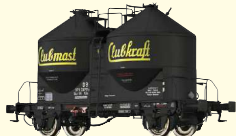
Staubbehälterwagen Kds 56 "Clubmast Clubkraft" der DB Betriebs-Nr. 579 337 [P]
