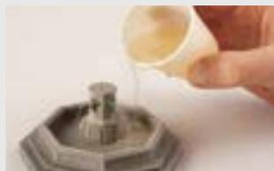
Anschließend füllen Sie NOCH 2K-Wasser-Gel in das Bassin des Brunnens.
