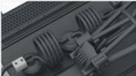
Störstromfilter aus feinstem Metalldraht
