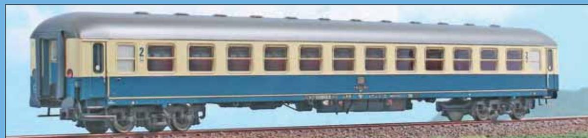
Carrozza Tipo X di seconda classe Bm<sup>234</sup> in livrea blu/beige delle DB.
