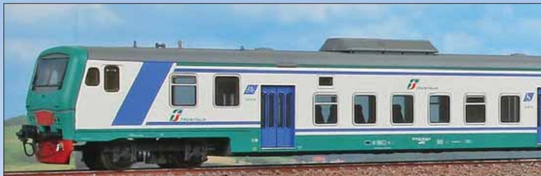
Treno vicinale FS Tipo 1973 a piano ribassato, formato da una locomotiva E.464, una vettura di 2<sup>a</sup> classe e una vettura pilota ricostruita, entrambe climatizzate. Livrea XMPR attuale.
